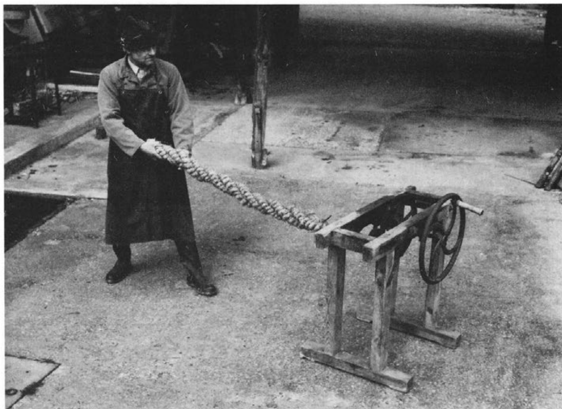
Handgetriebenes Seegrasspinnrad mit gesponnenem Seegraszopf und Spinner.
