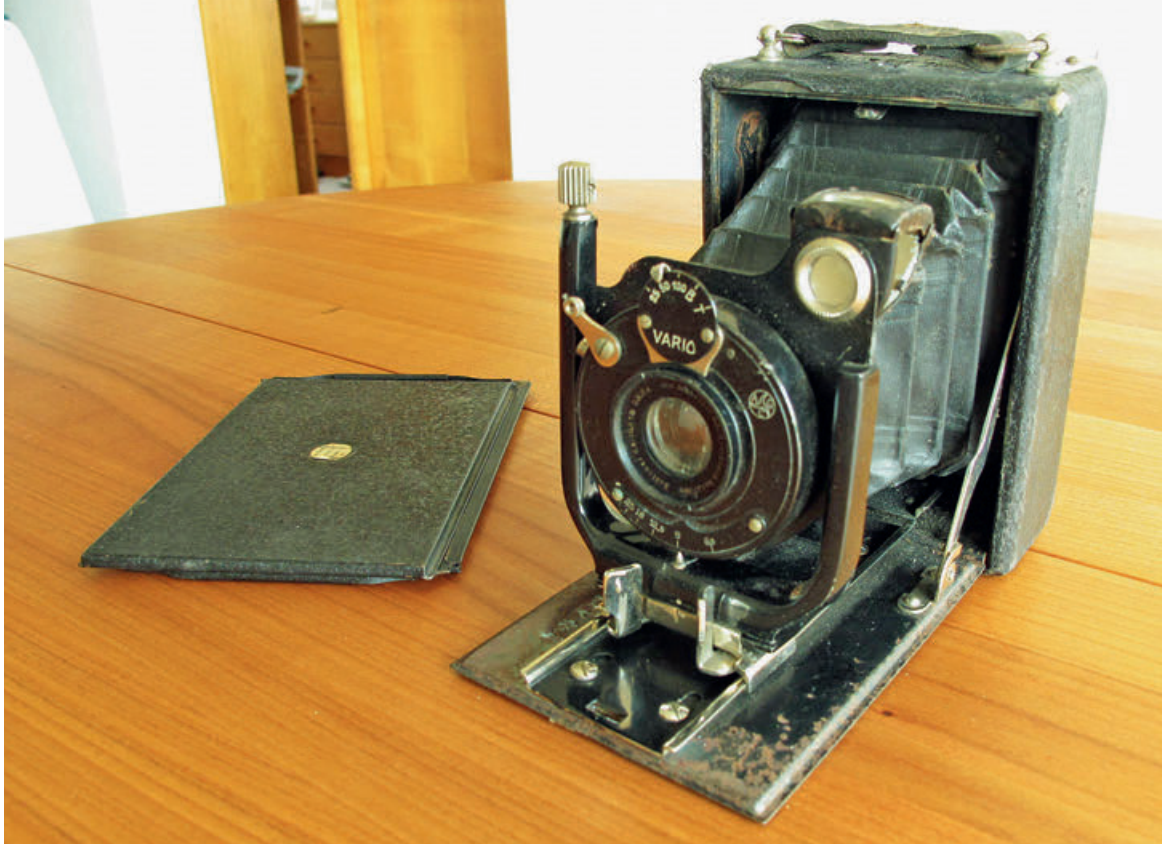
Plattenkamera und Glasplattenkassette (Format 9x12 cm).
