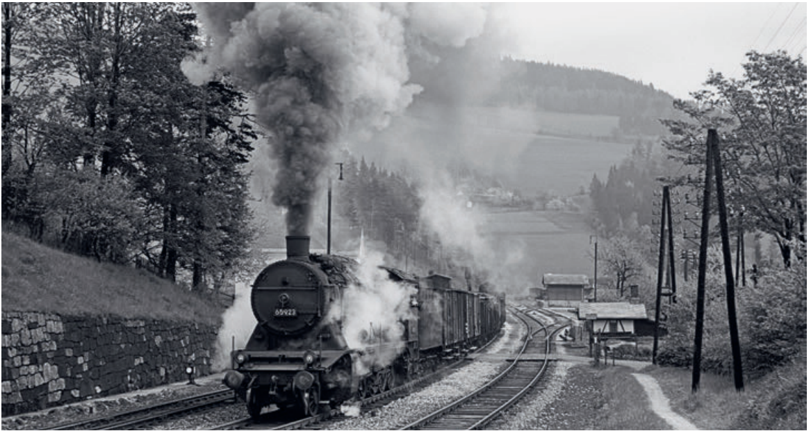
Die nach dem Krieg in Österreich gebliebenen württembergischen Maschinen der Reihe K, Reichsbahnbaureihe 59, besaßen wegen des auslaufenden Unterhalts das gleiche Zylinderproblem wie die technisch verwandte C-Type. Deshalb fanden sie an sich nur noch als Schiebelok Verwendung – da muss das Lokpersonal nicht die Signale erkennen, die vorne für die ziehende Lok gelten. Hier ist Lok 659.23 ausnahmsweise an die Spitze eines Zuges gesetzt – die Problematik der Sichtbehinderung zeigt sich auch hier deutlich. Foto: Harald Navé, Slg. Alfred Luft.
