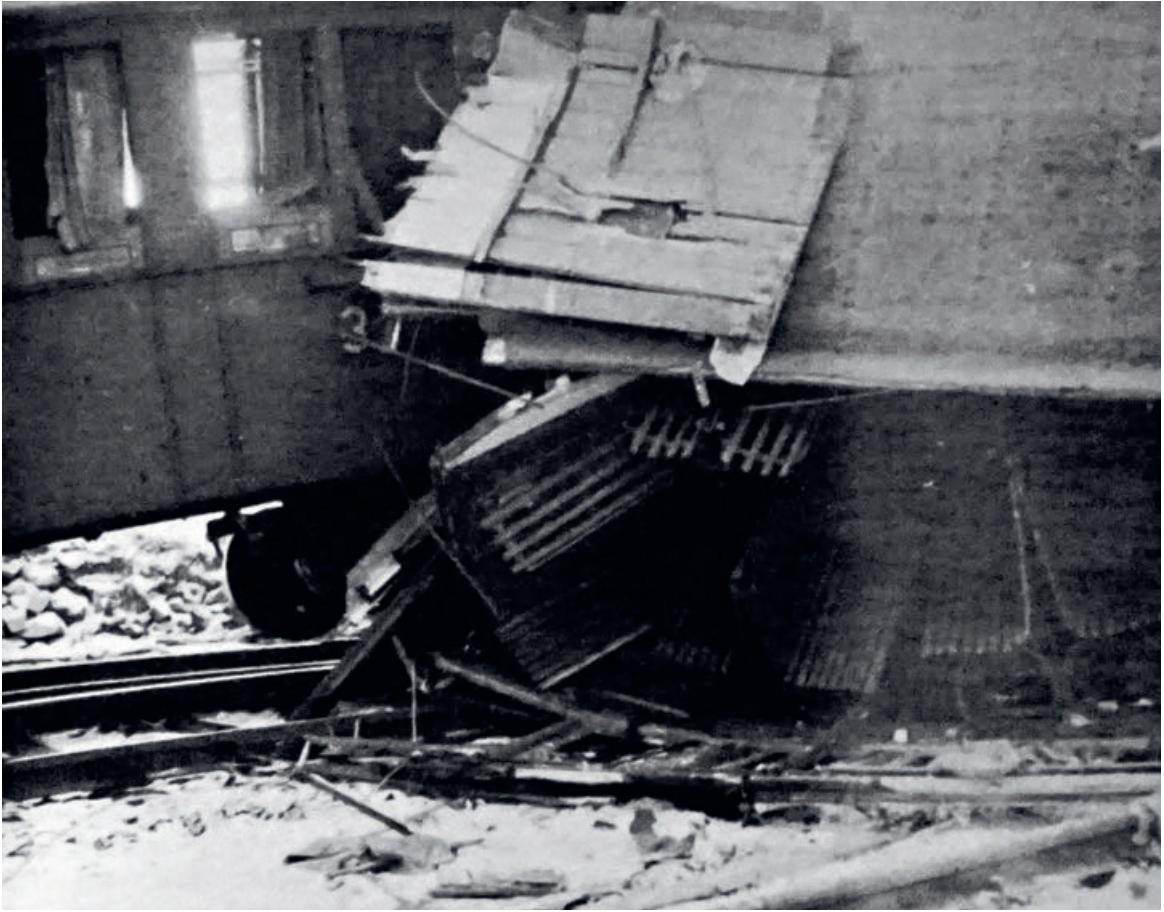
Während die Insassen der zwei am meisten betroffenen Personenwagen mit schwersten Verletzungen oder Tod rechnen mussten, wie man an der völlig fehlenden Seitenwand und den herauskippenden Sitzbänken sieht, kamen die Fahrgäste der davor und dahinter eingereihten Wagen meist mit dem Schrecken davon. Foto: Polizei Biberach, Repro 1983.
