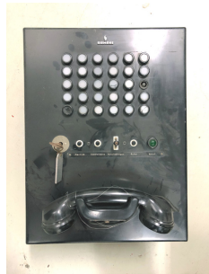
Abb. 9: Feuermelder um 1960 wie er bis zuletzt auch am Feuerwehrhaus in der Ehinger Straße 24 betrieben wurde; Abb. 10: Feuermelderempfangsanlage aus dem Zeughaus; Abb. 11: Wecker der Weckerlinie um 1960 mit Metallgehäuse für den Außenbereich; Abb. 12: Wecker der Weckerlinie um 1960 mit zweifacher Klingel, Feuerwehrhaus Ehinger Straße 24.
