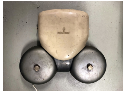
Abb. 9: Feuermelder um 1960 wie er bis zuletzt auch am Feuerwehrhaus in der Ehinger Straße 24 betrieben wurde; Abb. 10: Feuermelderempfangsanlage aus dem Zeughaus; Abb. 11: Wecker der Weckerlinie um 1960 mit Metallgehäuse für den Außenbereich; Abb. 12: Wecker der Weckerlinie um 1960 mit zweifacher Klingel, Feuerwehrhaus Ehinger Straße 24.
